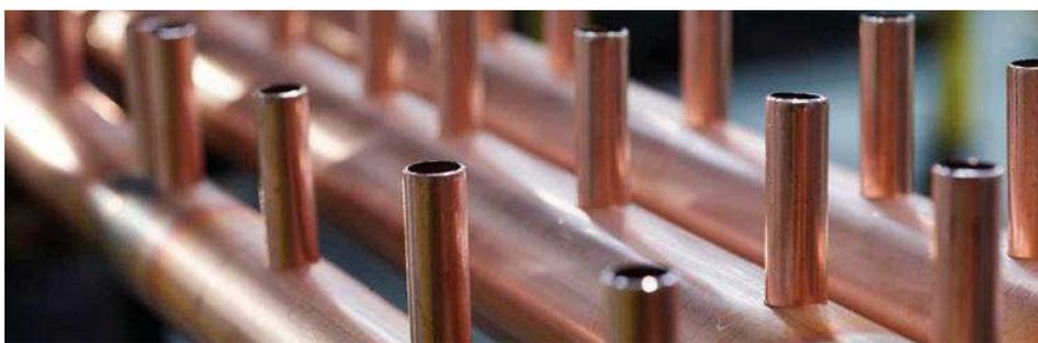
I collettori degli scambiatori, prodotti internamente, vengono realizzati in rame mediante un centro di lavoro e una bombatrice di ultima generazione. Le estremità opposte dei collettori vengono poi realizzate in maniera differente a seconda del tipo di funzionamento dello scambiatore stesso.
