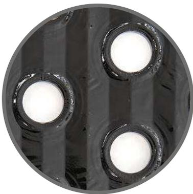
Trattamento di verniciature per elettrodeposizione. Indicata come verniciatura di fondo consiste in un film di vernice per elementi in ferro, acciaio e altre leghe. Garantisce eccellente resistenza alla corrosione nei confronti degli agenti atmosferici e di altri tipi di attacchi, permettendo inoltre una migliore adesione delle vernici a polveri. Questo tipo di verniciatura presenta una scarsa resistenza all'esposizione UV, pertanto non è adatta all'esposizione diretta ai raggi del sole.
