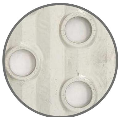
La stagnatura è un trattamento elettrolitico per immersione, adatto alla protezione di qualsiasi metallo quale rame, ferro, alluminio e loro leghe. I rivestimenti compatti di stagno sono apprezzati per il loro valore protettivo di fronte agli eventi atmosferici, alle acque, alle soluzioni ed a varie sostanze, tra cui gli alimenti. Oltre ad assicurare buona resistenza alla corrosione, la stagnatura possiede ottime proprietà estetiche ed una elevatissima conducibilità elettrica.
